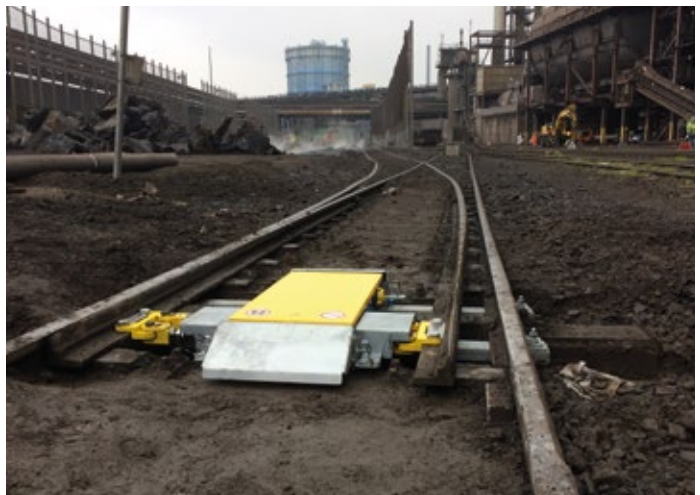
Weichenantrieb WA 160i-V im Einsatz bei Thyssenkrupp Steel Europe AG, Duisburg. Point machine WA 160i-V in use at Thyssenkrupp Steel Europe AG, Duisburg.
