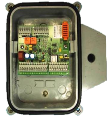
Baugruppe ESD im Signalkabelverteiler
